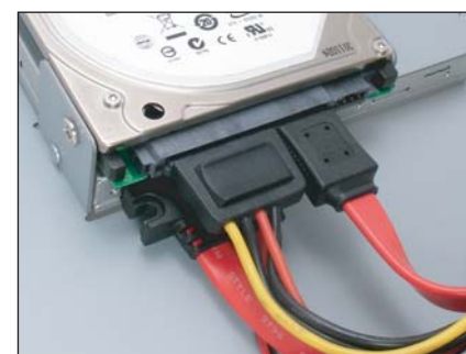
2.5インチ HDD の SATA コネクターを接続します。
