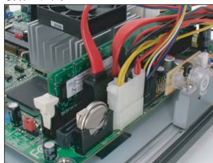
HDD, ODD の SATA および電源コネクターをマザーボードに挿入します。
